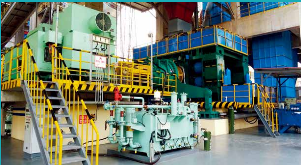
▼ 中建材（合肥）粉体生料辊压机
